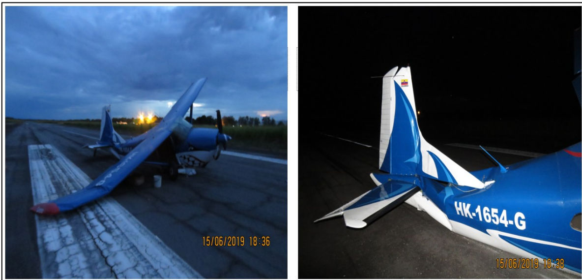
Fotografía No. 3: daños estructurales en zonas mayores de la aeronave HK-1654G
